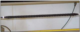
Das System cobra lässt im unteren Lastbereich wesentlich stärkere Schwingungen zu. Die Auslenkung der gesicherten Stämmlinge ist dadurch bereits bei schwachem Wind mehr als doppelt so groß. Ohne Ruckdämpfer weist die cobra-Verbindung bei 100 daN allerdings eine geringere Dehnung auf als die untersuchten Libre-Sicherungen mit Spleißtex 25 und 35.
