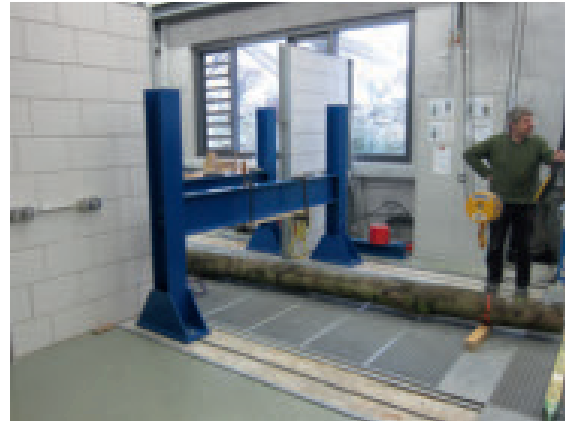
Abbildung 2: Versuchsaufbau 4-Punkt-Biegung. Die Enden der Stämme wurden mit Lastkränen beidseitig mit ca. 5 m Abstand angehoben (rechts). Die Mitte des Stammes wurde von zwei Traversen (links) im Abstand von 90 cm nach unten gedrückt
