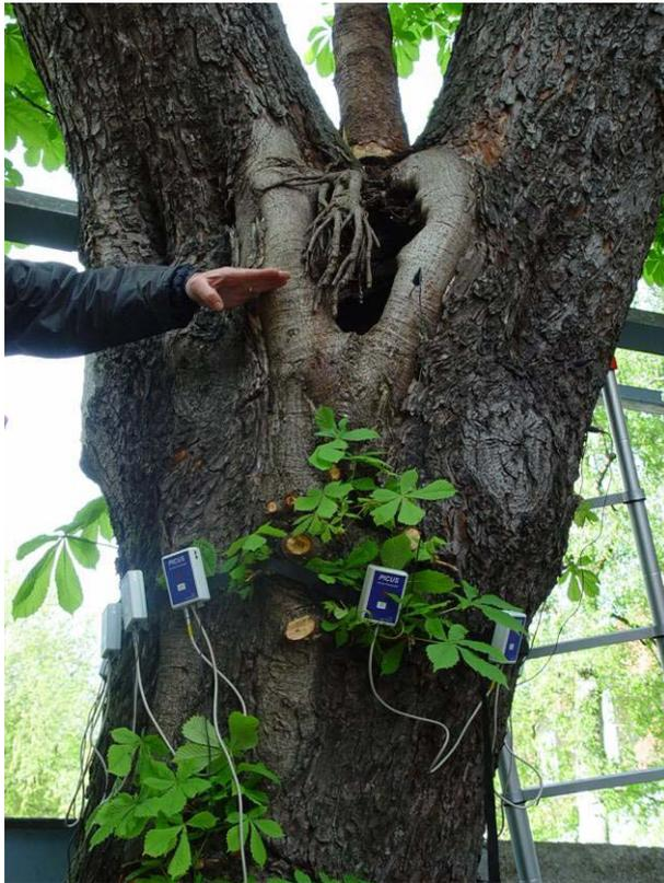
Unzweifelhaft war die statische Ausgangssituation durch verschiedene Vorschädigungen als geschwächt zu beurteilen. Hier sind insbesondere die Höhlung mit Fäulnis im Stammkopfbereich des Baumes in rund 3 m Höhe und die asymmetrische Kronenform durch Kappung eines Stämmings zu erwähnen. Inwieweit die Vorschädigung jedoch zu einer erhöhten Bruch- oder Kippgefahr bei beginnenden Orkanböen führt, war zunächst unklar.
