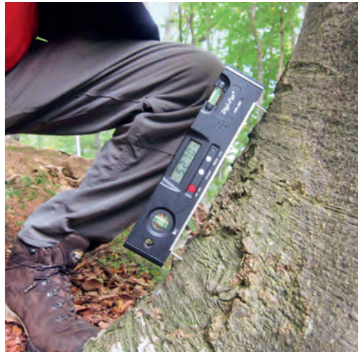
■ Abb. 6: Neigungsmessung mit digitaler Wasserwaage.
