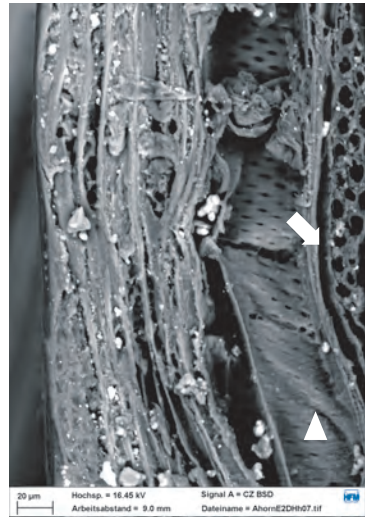
■ Abb. 3 (li.) Rasterelektronenmikroskopische Aufnahme. Rissbildung am Ende eines Holzstrahls (Blockpfeile) und durch eine Holzfaser (Spitzpfeil). Tangentialschnitt.
