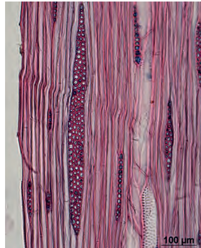
■ Abb. 2: Lichtmikroskopische Aufnahme einer Stauchungszone, Verlauf von oben links nach Mitte rechts; Tangentialschnitt. M. Risse, Holzforschung München.
