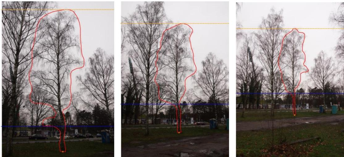
Abbildung 1: *Bildgrundlage für die Schätzung der Windlast für Baum 61, Höhe 22 m. Abstand 15.4, 20.3 und 27.6 m, geschätzte Windlast 155, 143 und 123 kNm*
