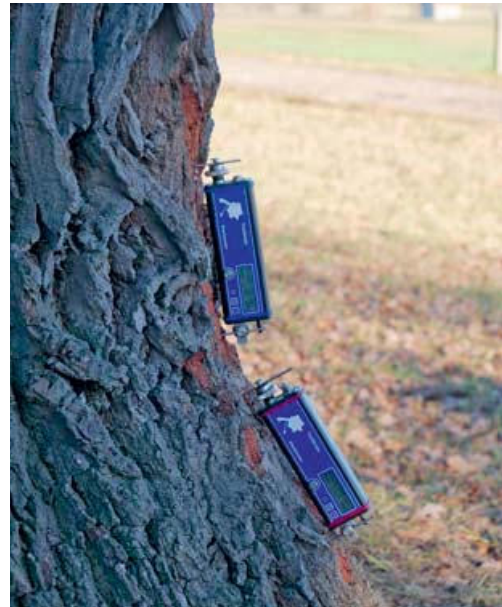
Abb. 4: Die Messung ohne dehnungslose Verformung ist nur ober- u. unterhalb des abknickenden Faserverlaufs möglich. Im gekrümmten Bereich zwischen den abgebildeten Elastometern werden um ca. 15-20 % überhöhte Messwerte aufgezeichnet.
