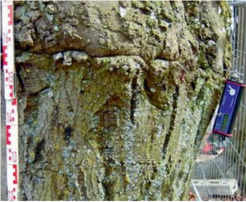
Abbildung 5: Rindeneinschlüsse verfälschen die Messung: oben an einer Veredelungsstelle, ...
