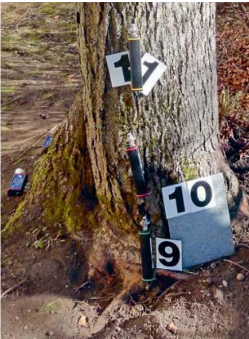
... unten an einer Würge wurzel (Elastometer Nr. 9, Bilder nachgestellt).
