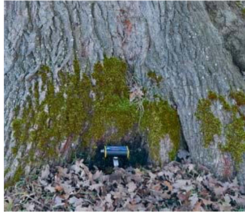
Abbildung 6: Inclinometer müssen so tief wie möglich am Stammfuß angebracht werden, sollten aber möglichst nicht auf Wurzeln platziert sein.
