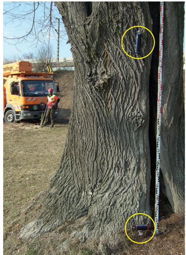
Abbildung 3: Aufbau eines Zugversuchs an einem Naturdenkmal
