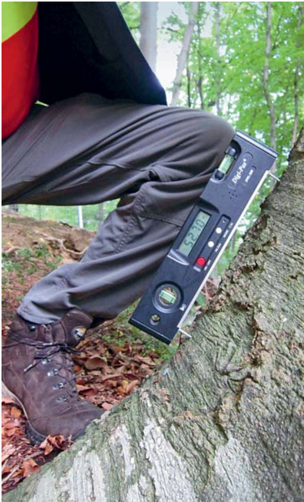
Abbildung 10: Neigungsmessung mit digitaler Wasserwaage
