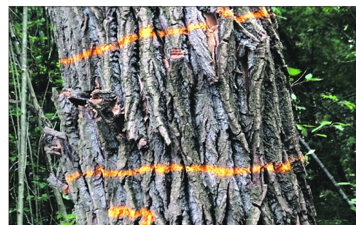
Bei bereits nachlassender Zugkraft bildeten sich diese deutlich sichtbaren Quetschungen und Rindenablösungen auf der Druckseite von Baum 7.
