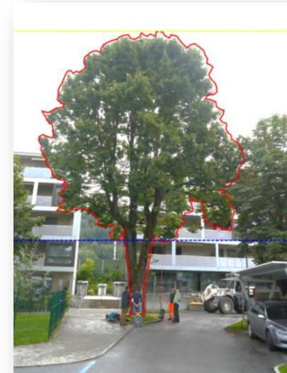
Ein Foto des Baumes in Richtung der Zugachse wird übertragen und der Kronenrand wird digitalisiert, um die Windangriffsfläche des Baumes zu ermitteln.
