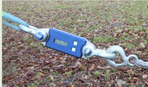
Die Messdaten aller Geräte werden während der Messungen zu einer Zentraleinheit gefunkt und in einer Datei abgelegt
