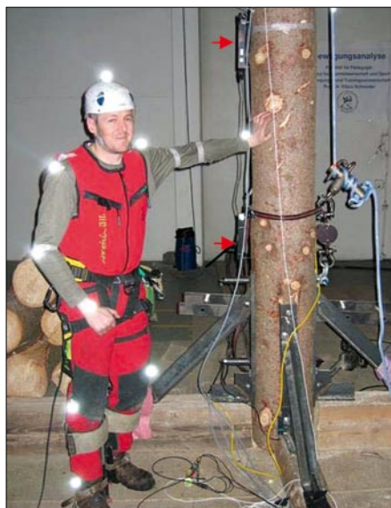
Abb. 2: Marker zur Analyse der Bewegungen des Kletterers: Zwei Elastometer (rote Pfeile) messen die Dehnung der Randfasern, wenn sich der Stamm unter Belastung biegt. In diesem Fall wird der Stamm nach rechts ausgelenkt, wodurch die untersuchten Fasern gedehnt werden. Der Stammfuß wurde mit Stahlprofilen auf Holzbalken befestigt. Die Stammspitze war frei beweglich. Vor den Falltests wurde die Flexibilität der Spitze in Zugversuchen überprüft.
