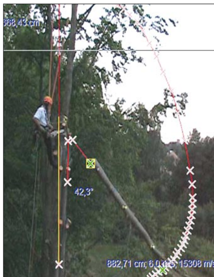
Abb. 6: Flugbahnen eines Stammstücks (links) und eines Kronenteils (rechts), markiert ist jeweils der Schwerpunkt des Abschnitts
