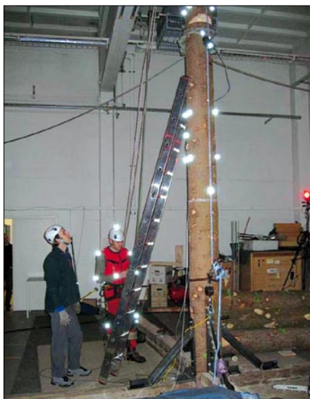
Abb. 1: Versuchsaufbau: Am Rigging-System und am Baum wurden Marker angebracht, um folgende Bewegungen aufzuzeichnen: die Flugbahn des Stammstücks, Dehnung und Nachrutschen der Schlinge am Anschlagpunkt, die Biegung des Stammes und die Dehnung im Ablassseil. Im Hintergrund sind die roten Leuchtdioden einer der acht Hochgeschwindigkeitskameras zu erkennen, die die Bewegungen aufzeichneten.
