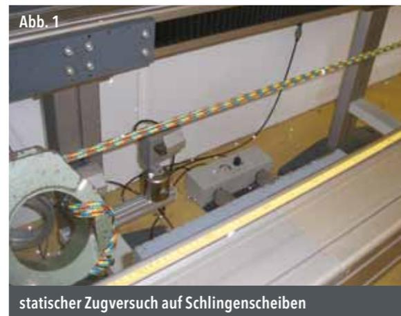
Abb. 1 statischer Zugversuch auf Schlingenscheiben
